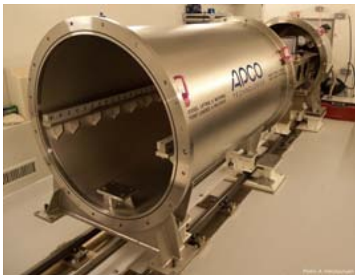
Fig. 4: HARPS-N - High Accuracy Radial Velocity Planet Searcher-North, al fuoco del Telescopio Nazionale Galileo dal 2012, è lo spettrografo gemello di HARPS montato al Telescopio di La Silla in Cile oltre una decina di anni fa. Grazie ad HARPS-N è possibile determinare la massa del pianeta. Crediti: Università di Ginevra/TNG.
